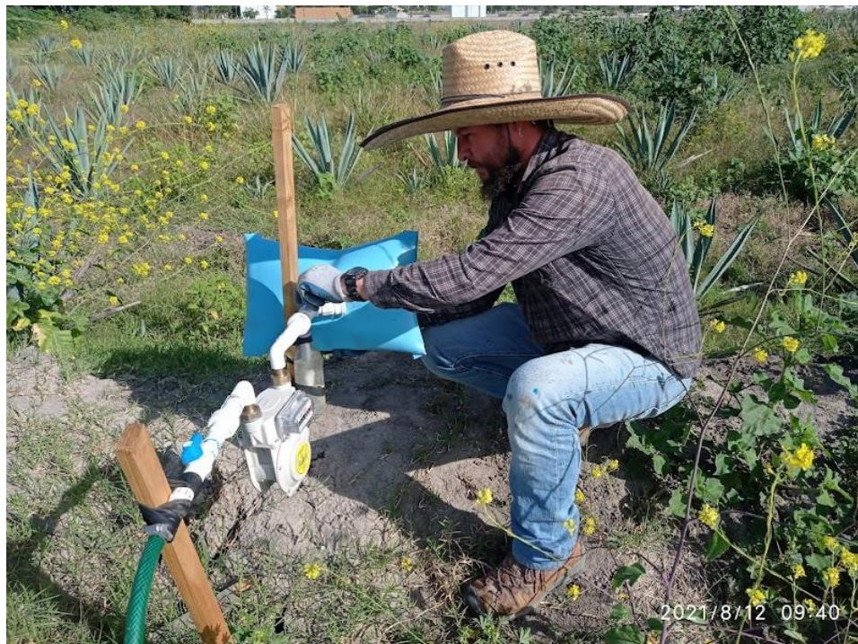
Anexo 25. Recolección de muestra de efluente del biodigestor para su análisis fisicoquímico.
