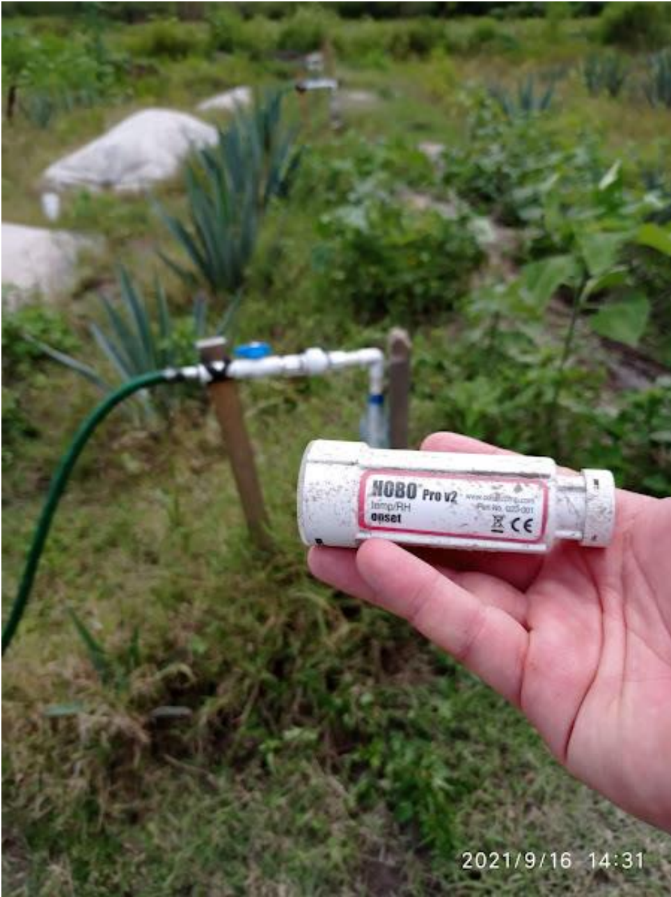
Anexo 9. Sensor de temperatura y humedad relativa HOBO usado en el sitio del experimento con biodigestores tubulares a escala real.
