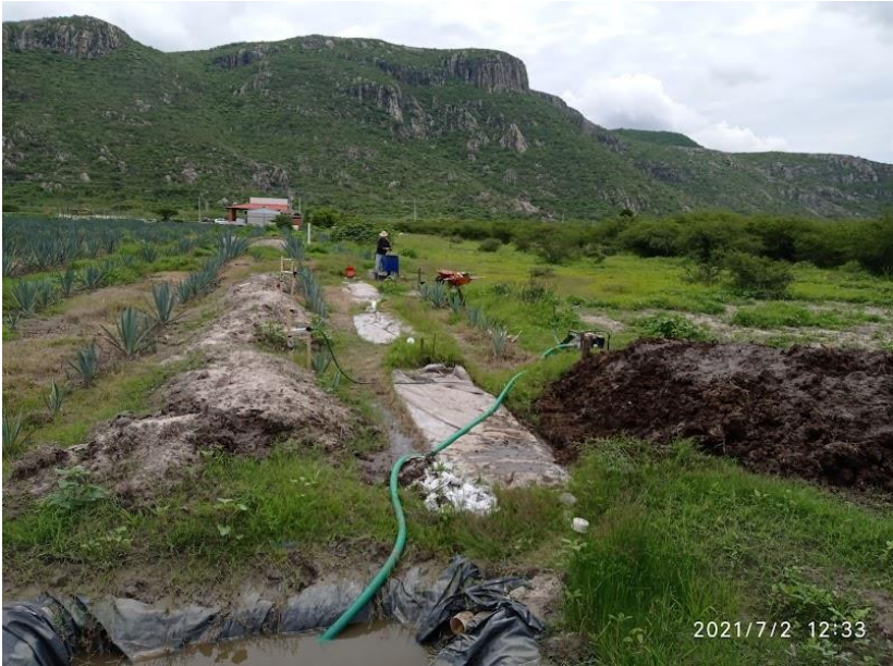
Anexo 17. Alimentación del biodigestor con la mezcla de estiércol de bovino y agua.
