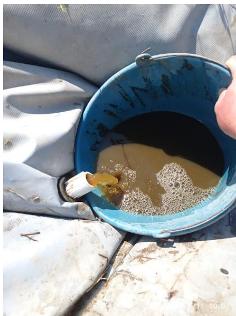
Anexo 25. Recolección de muestra de efluente del biodigestor para su análisis fisicoquímico.
