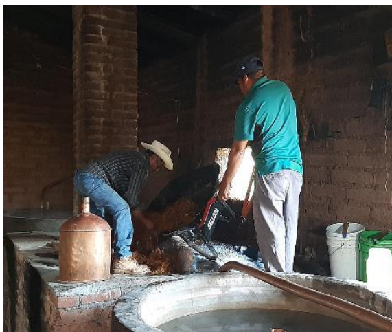
Figura 21 Carga de la olla para iniciar la destilación
