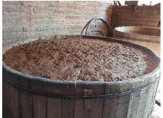
Figura 20 Fermentación del maguey en la tina de madera
