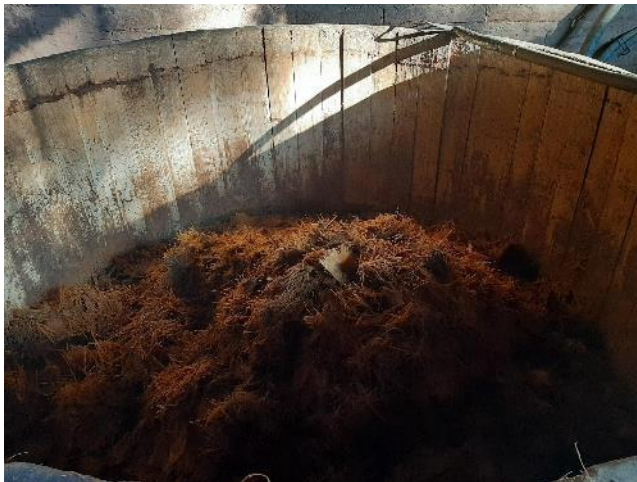
Figura 19 Esparcimiento del maguey machacado en la tina de madera
