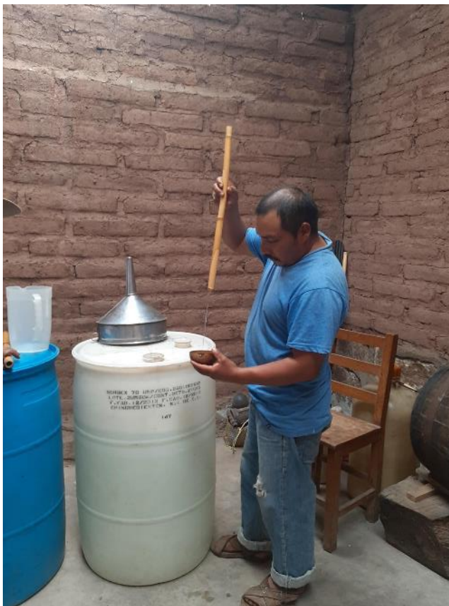
Figura 24. Graduación alcohólica del mezcal mediante el mezclado del primer y segundo destilado
