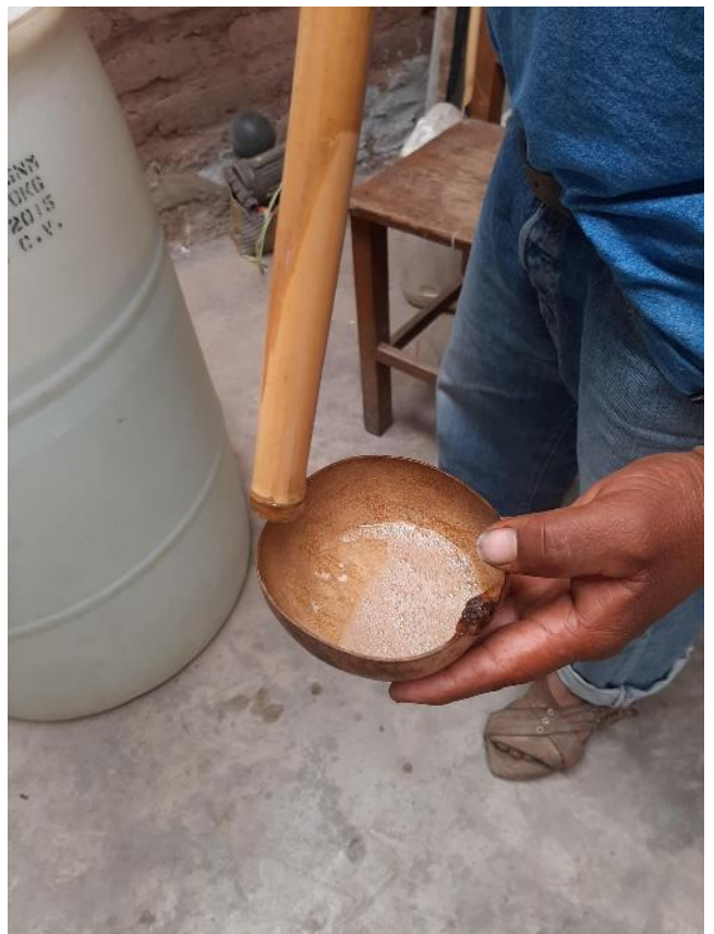
Figura 25. Verificación del grado alcohólico mediante los saberes ancestrales del maestro mezcalero
