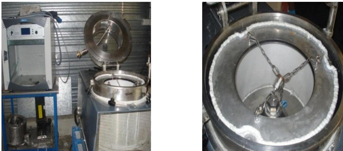
Fig. 3.1 Centrífuga vertical marca Robatel, en la cual se realizaron los experimentos
