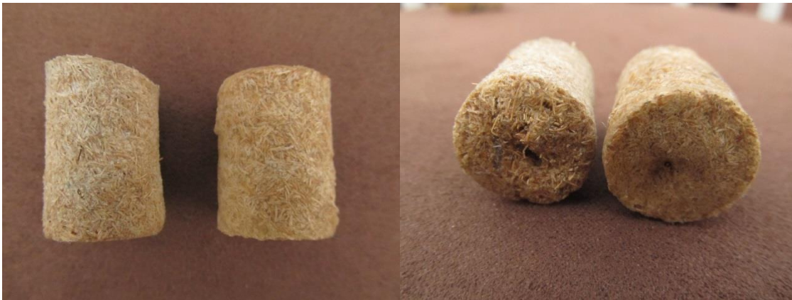
Figura 3. Imágenes de las probetas, posteriores a la prueba de fuerza de extracción, en ambos casos el material con tratamiento se encuentra a la derecha; y el material sin acabado a la izquierda.
