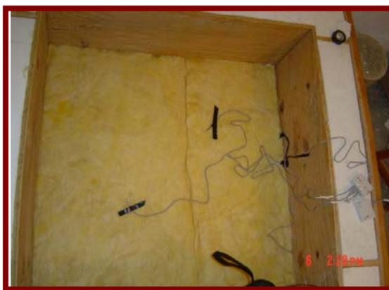
*Figura 27. Colocación de termopares en la fibra de vidrio para la prueba operativa.*
