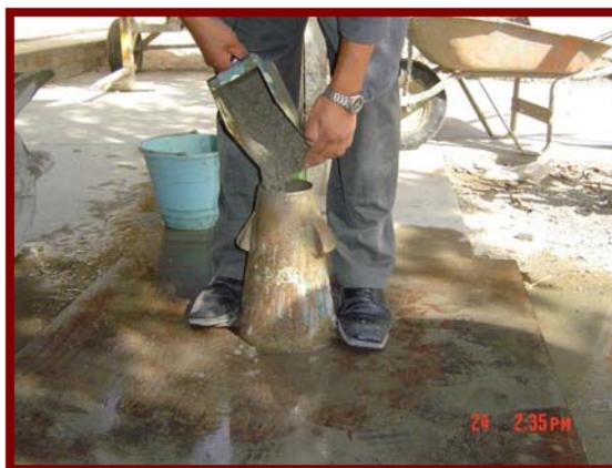
*Figura 19. Procedimiento para verter el mortero en cono de Abram's*
