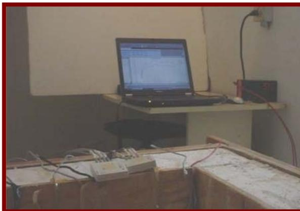
*Figura 26. Equipo de medición de temperaturas y adquisición de datos para determinar la conductividad térmica de CM.*
