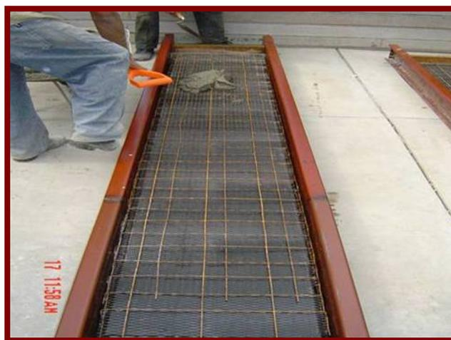
Figura 32. Cimbra empleada para la fabricación de elementos prefabricados que consiste en una base metálica en forma de "U" invertida y dos retenedores laterales.
