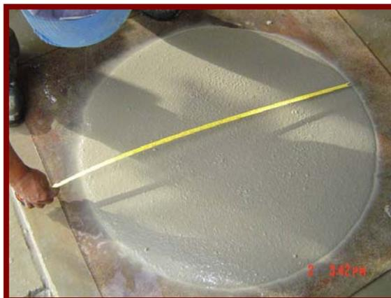
*Figura 20. Determinación de extensibilidad de flujo del mortero fluido*
