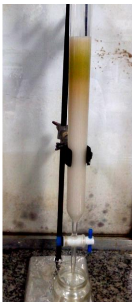
Figura 15. Columna PCR conteniendo Sephadex LH-20 como fase estacionaria. Precipitado acuoso de Agave nussaviorum , Eluente Metanol
