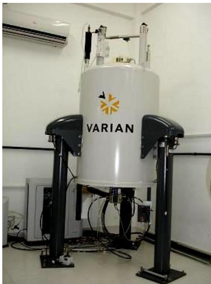
Figura 8. Espectrómetro de Resonancia Magnética Nuclear (Fuente: http://www.uff.br/laremn/ )
