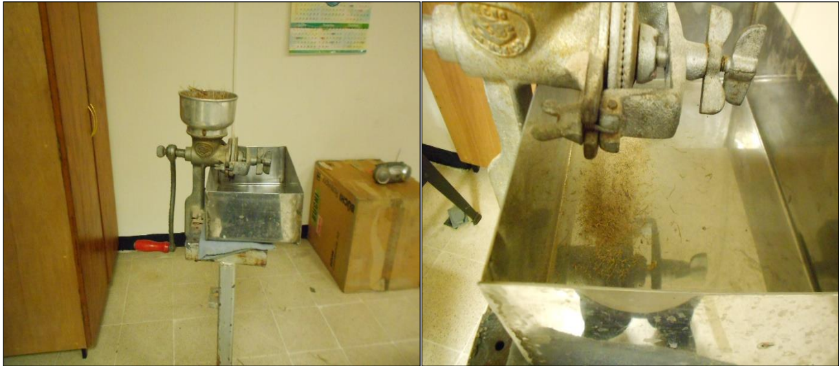
Ilustración 13 - Pretratamiento mecánico del bagazo de Agave angustifolia Haw.
