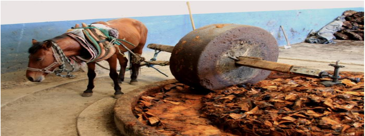
Ilustración 8 - Proceso de molienda del Agave angustifolia Haw.
