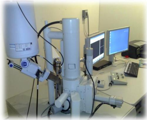
Fig 8. Microscopio de barrido electrónico
