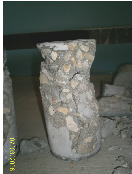
Ilustración 10: Detalle de la falla de un espécimen.
