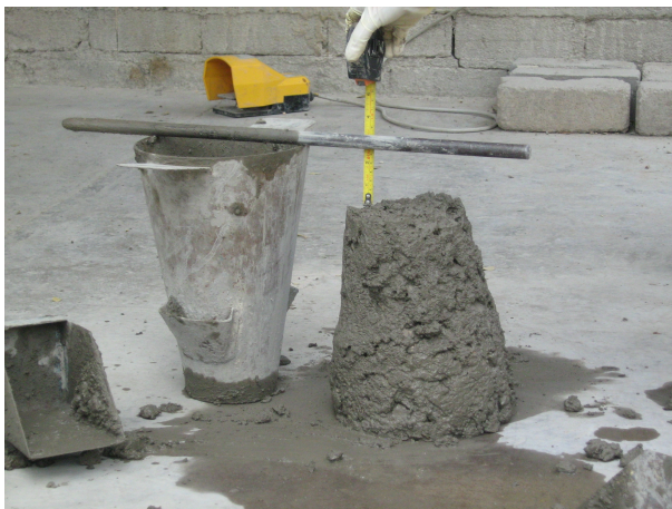
Ilustración 6: Prueba de revenimiento.
