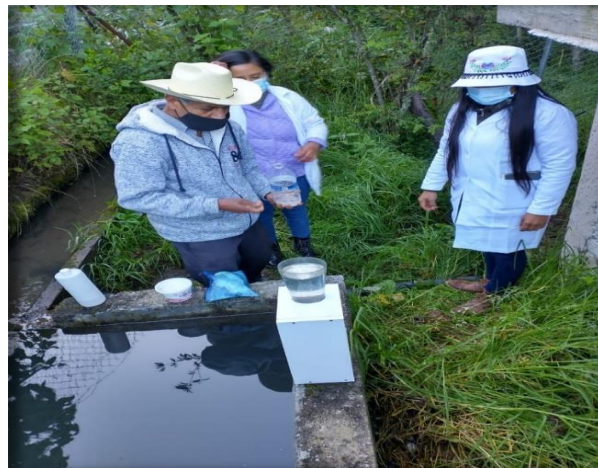
Figura 16. Preparación de la muestra de sólidos sedimentables en el agua por el productor en la UPA “Rancho Cara de León”.
