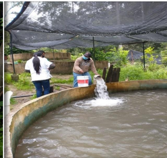
Figura 12. Medición de gasto de agua en los estanques de entrada en la UPA “El Cajete”:
