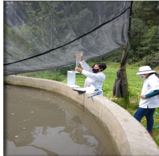
Figura 10. Preparación de la muestra por el técnico para sólidos sedimentables en la UPA “El Cajete”.
