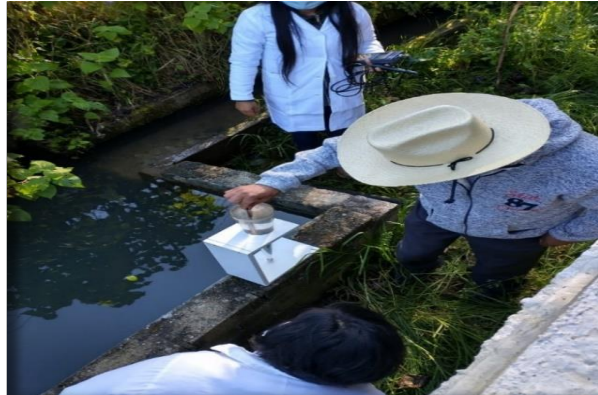
Figura 14. Agitación de la muestra de sólidos sedimentables en el agua, por el productor en la UPA “Rancho Cara de León”.
