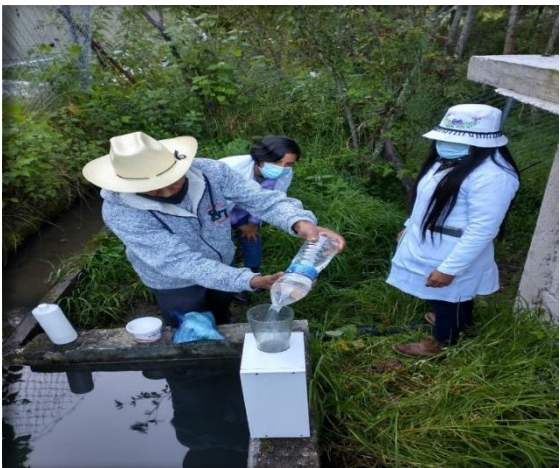
Figura 15. Preparación de la muestra de sólidos sedimentables en el agua por el productor en la UPA “Rancho Cara de León”.
