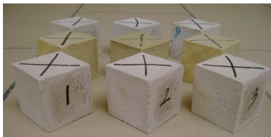
Figura 18. Especímenes de mortero cal-puzolana.
