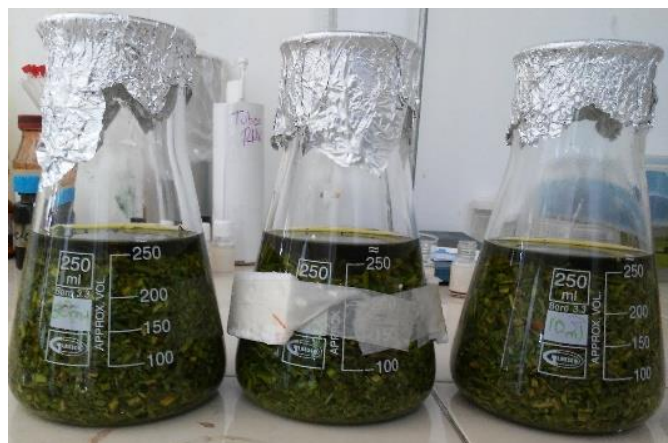
Figura 3.2. Preparación del sistema disolvente - hoja de agave para la extracción.
