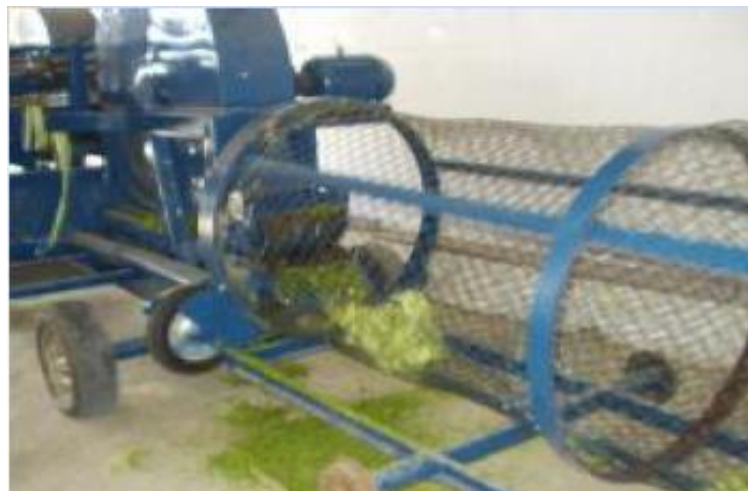
Figura 7. Separador de fibras y material de desecho.
