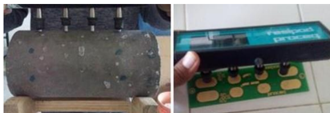
Figura 27. Prueba de Resistividad Eléctrica en concretos y equipo Resipod
