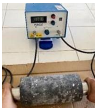
Figura 26. Arreglo para la medición de la VPU utilizando el equipo PUNDIT
