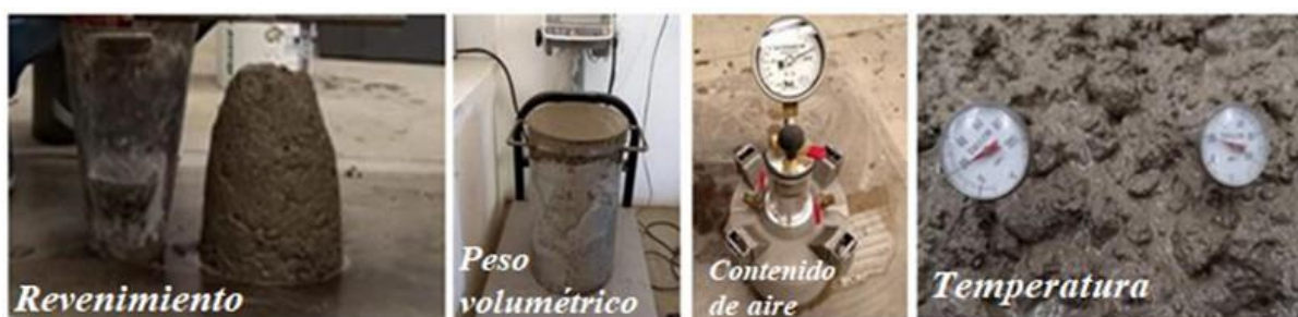
Figura 23. Secuencia de caracterización de las mezclas de concreto en estado fresco
