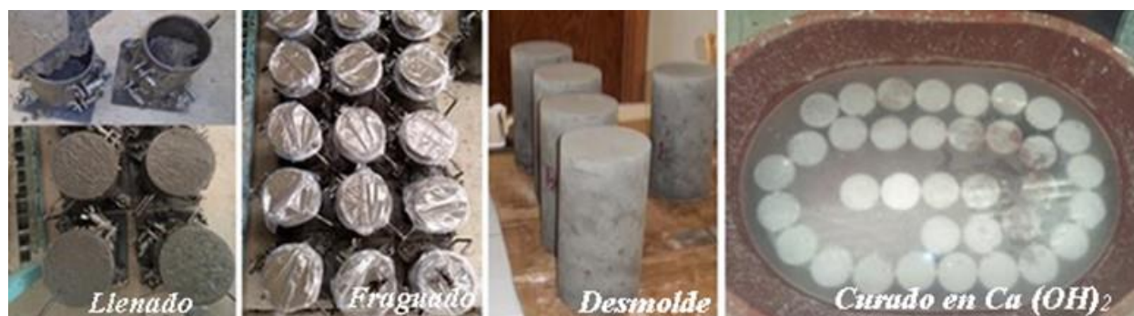
Figura 24. Elaboración y curado de especímenes
