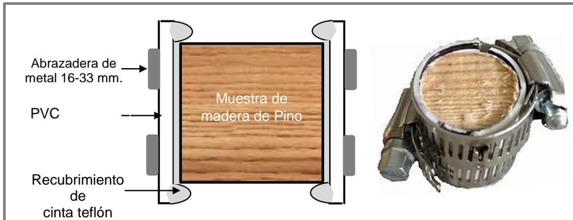
Figura 11. Muestras de madera utilizadas por la técnica de resonancia magnética nuclear.
