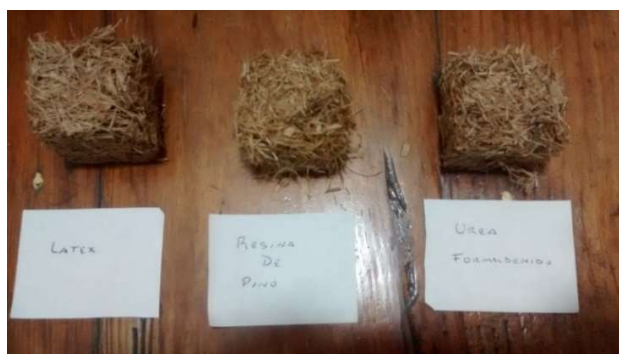
Figura 38. Aspecto de las muestras al momento de desmolde
