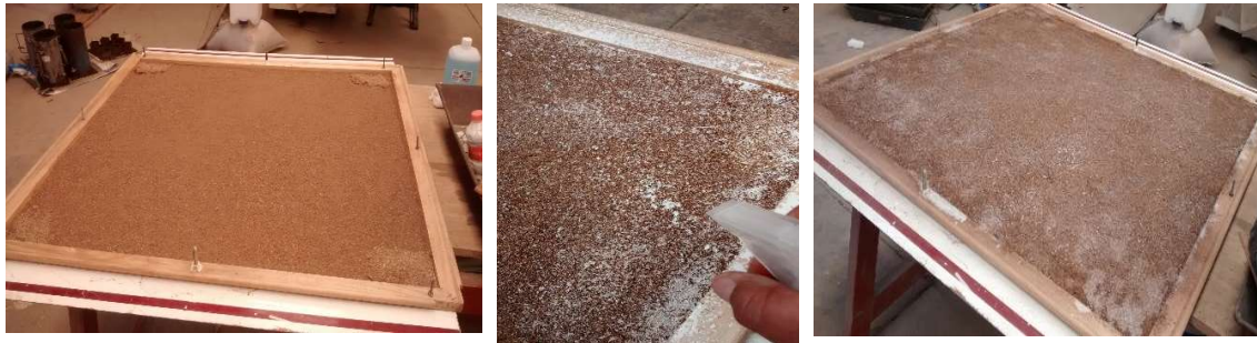
Figura 26. Fabricación del panel biocompuesto por capas y atomización
