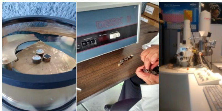
Figura 3.13 a) metalizado de las muestras, b) acomodo de las muestras para su análisis y c) Microscopio electrónico de barrido JEOL 6300
