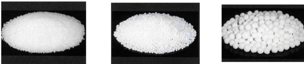
Figura 2.12 Distintos tamaños de gránulos de urea obtenidos mediante prilling. Fuente: TOYO Engineering Corporation
