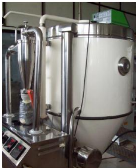
Figura III.2 Secador por aspersión escala piloto Niro-atomizer.
