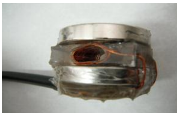
Figura 3. 10 Sensor 3 de NMR miniatura construido con magnetos circulares
