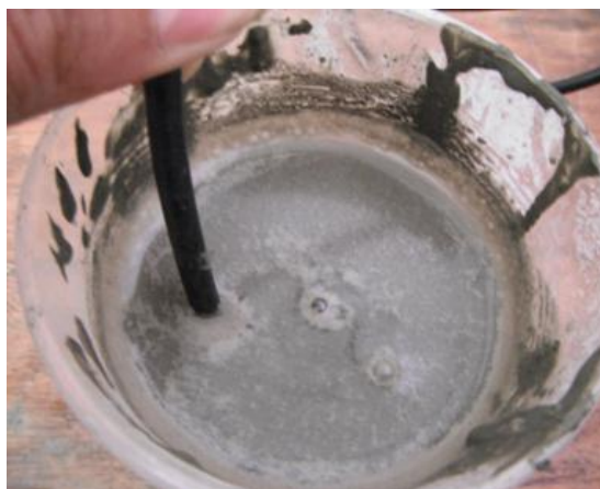
Figura 3. 17 Sensor sumergido en pasta de cemento (relación a/c=0.60) para observar los efectos en la respuesta a la frecuencia de la antena
