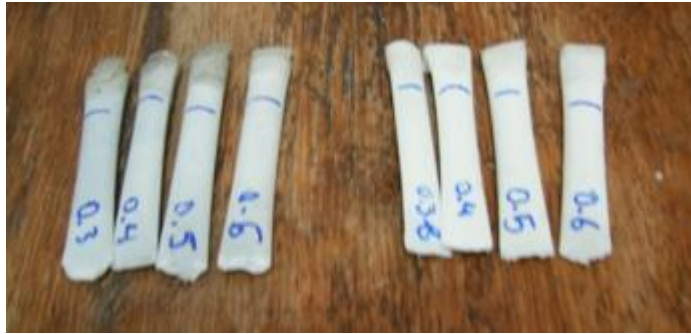
Figura 3. 14 Especímenes con pastas diferentes relaciones a/c, elaborados con cemento portland ordinario blanco y gris
