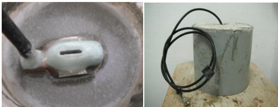
Figura 3. 18 Sensor miniatura NMR embebido dentro de una de las probetas de concreto
