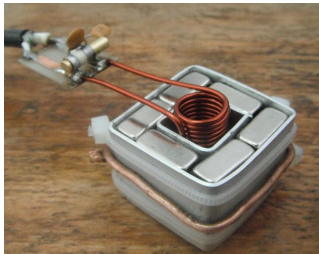
Figura 3. 4 Sensor 1 de NMR miniatura construido
