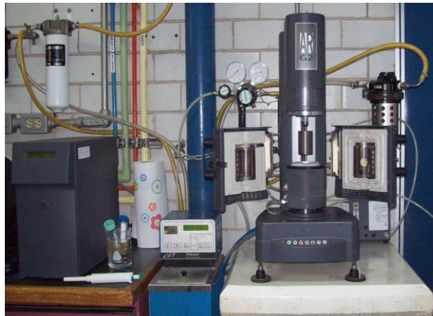
Figura 3.4 Reómetro de esfuerzo controlado modelo AR-G2
