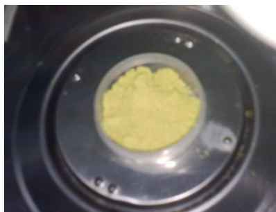
Figura 3.3 Determinación del contenido de humedad de los polvos.
