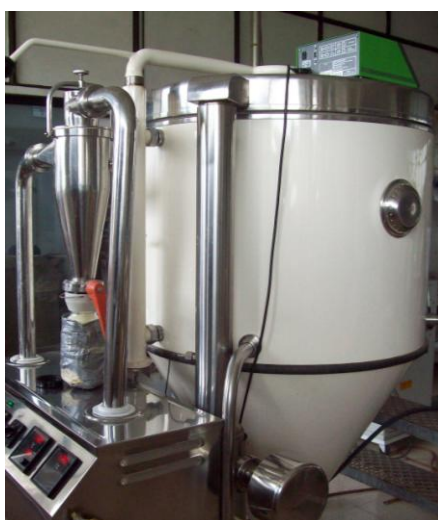
Figura 3.2 Secador por aspersion escala piloto Niro-atomizer
