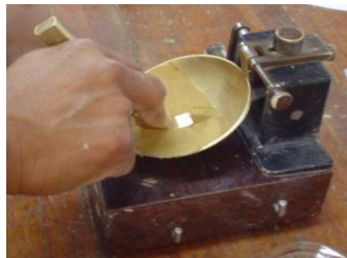
Figura 13 Preparación de la muestra para prueba de límite líquido
