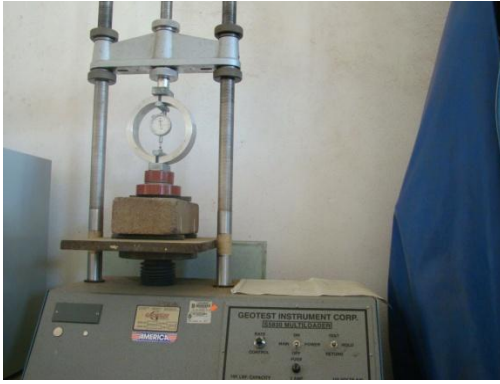
Figura 27. Especímenes de adobe compactado durante la prueba de resistencia a la flexión simple.
