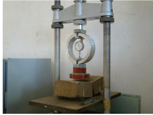
Figura 27. Especímenes de adobe compactado durante la prueba de resistencia a la flexión simple.
