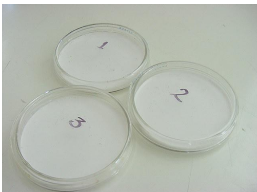
Figura 17 Muestra de látex previo a la prueba de contenido de sólidos totales
