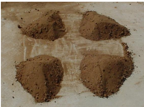
Figura 12 Cuarteo de muestra para elaboración de pruebas de granulometría
