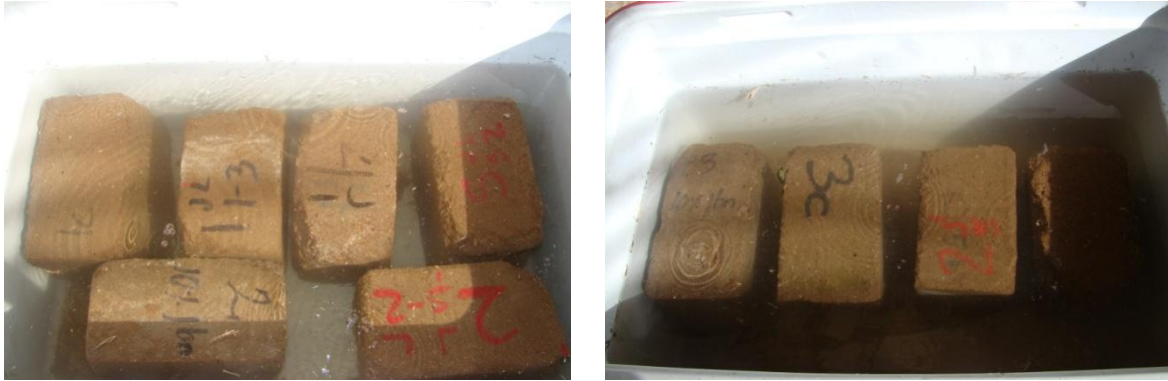
Figura 29. Especímenes de adobe compactado durante la prueba de absorción de agua por inmersión total
