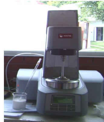
Figura 22 Preparación de la muestra de jabón y látex para prueba de reología
