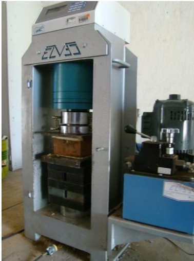
Figura 28. Especímenes de adobe compactado durante la prueba de resistencia a compresión
