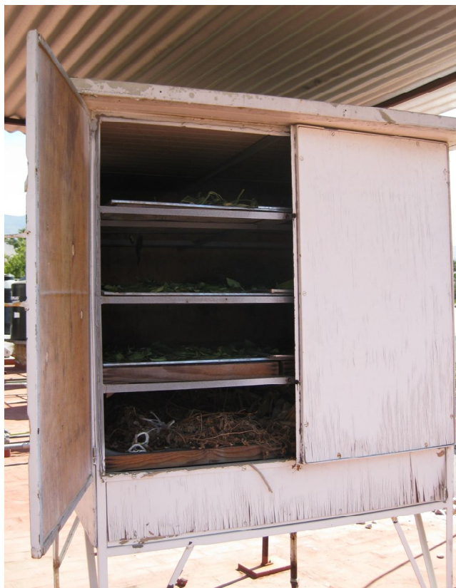
Figura 4. Secador empleado para deshidratar el material vegetal
