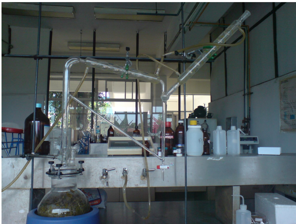
Figura 5. Dispositivo montado en el laboratorio para realizar las hidrodestilaciones convencionales con recirculación de aguas aromáticas.
