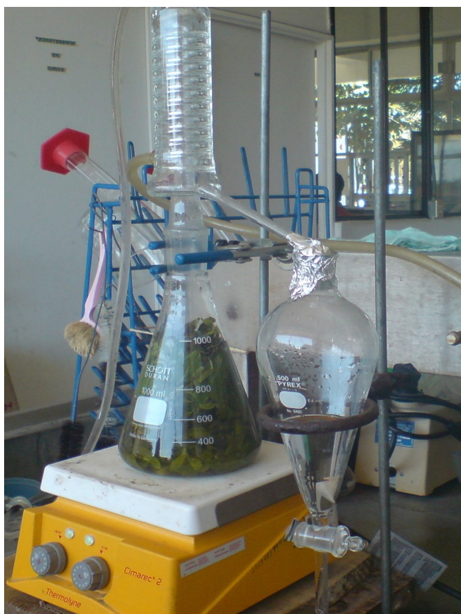
Figura 3. Dispositivo montado en el laboratorio para la hidrodestilación sin recirculación de aguas aromáticas
