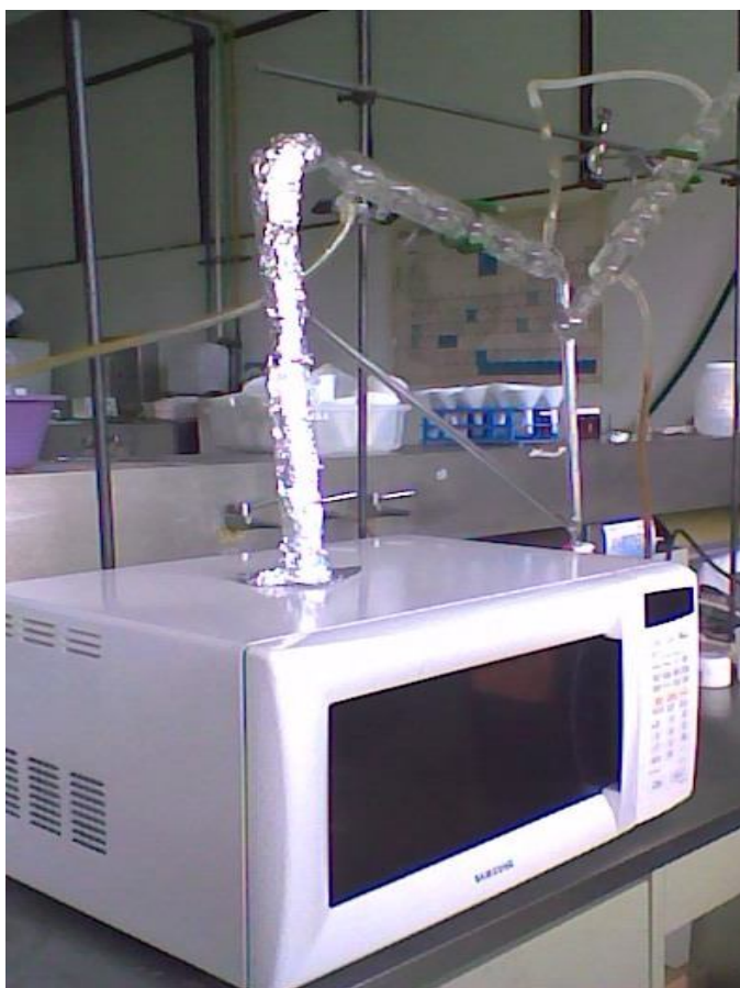
Figura 6. Dispositivo montado en el laboratorio para realizar hidrodestilaciones asistidas por microondas con recirculación de aguas aromáticas
