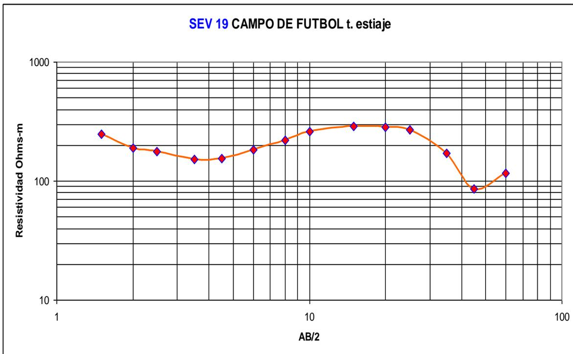
Figura 31. Gráfica de resistividad aparente en  $\Omega\text{m}$  contra  $AB/2$  en metros.
