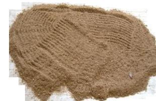
Se obtiene el peso volumétrico en un recipiente y en la báscula se pesa y se separa la grava mas gruesa de la muestra que no paso en la malla # 4 para obtener la granulometría gruesa.
