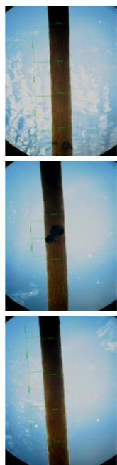
Vista longitudinal de 10 mm de las fibras del intervalo D_3 (0.60-0.79 mm) a 40X.
