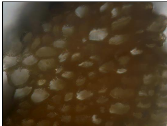
Figura 37. Arreglo microestructural de la fibra de bagazo (500x).
