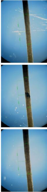
Vista longitudinal de 10 mm de las fibras del intervalo D_1 (0.20-0.39 mm) a 40X.
