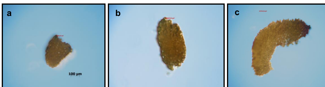
Sección transversal de fibras de los intervalos: a) D 1 (0.20-0.39 mm), b) D 2 (0.40-0.59 mm) y c) D 3 (0.60-0.79 mm) a 100X.
