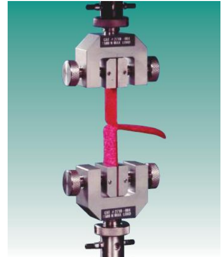
Mordazas con tornillo lateral de sujeción para prueba de materiales rango desde alambres finos hasta telas
