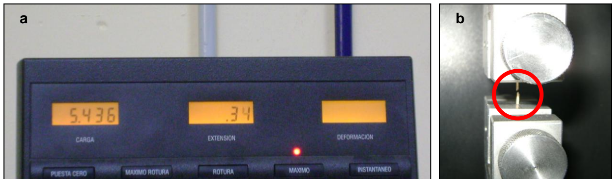
Figura 31. a) presentación de los resultados del ensayo; b) rotura de fibras individuales.
