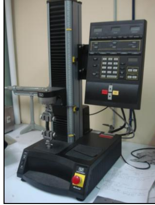
Figura 22. Máquina universal de pruebas Instron 4442.
