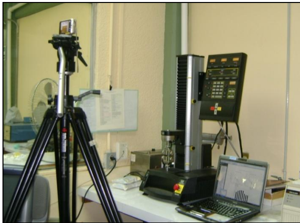
Figura 23. Texturómetro Instron modelo 4442 y cámara fotográfica.
