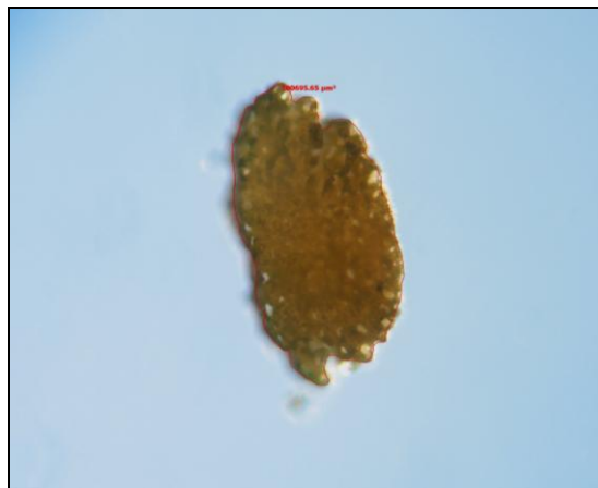
Figura 34. Sección transversal de las fibras de bagazo del intervalo D_2 (0.40-0.59 mm).
