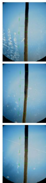
Vista longitudinal de 10 mm de las fibras testigo del intervalo D 1 (0.20-0.39 mm) a 40X.
