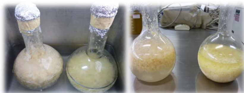
Figura 8. Proceso de extracción asistido por agitación con ultrasonido
