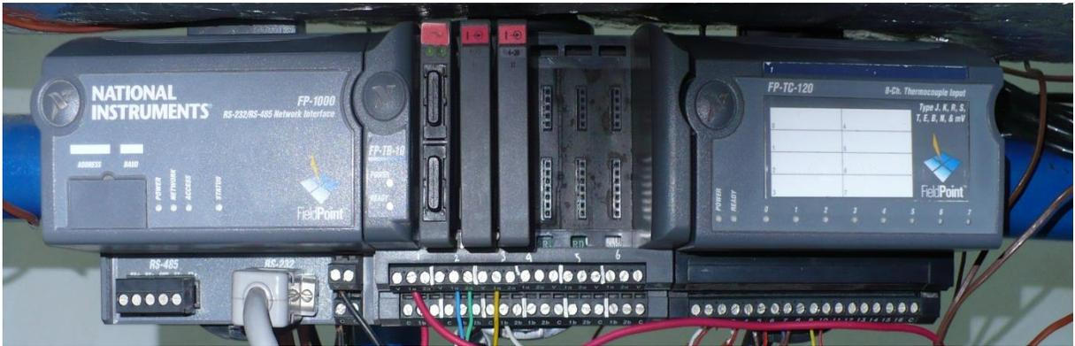
Figura 11-C), éste cuenta con ocho canales de entrada de mili voltaje para los diferentes termopares que existen en el mercado y en él se encuentran conectados cinco termopares.
