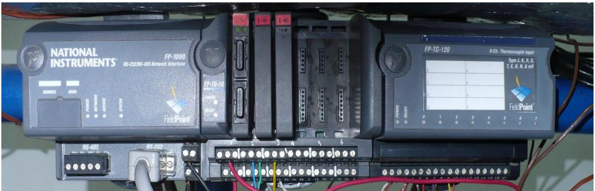
Figura 11-A) que comunica los módulos de salida con una computadora y el proceso; la comunicación entre la computadora y el modulo se hace por medio de un puerto serial RS-232.
