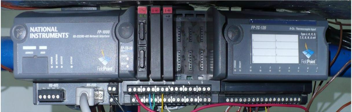
Figura 11) este realiza el control del proceso y la adquisición de datos en tiempo real.
