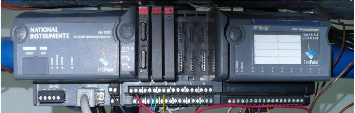
Figura 11-B) tiene incorporados submódulos. El primero de ellos corresponde a salidas booleanas y es donde se realiza el control del proceso; los otros submódulos son de adquisiciones de datos del proceso; en la placa de en medio (
