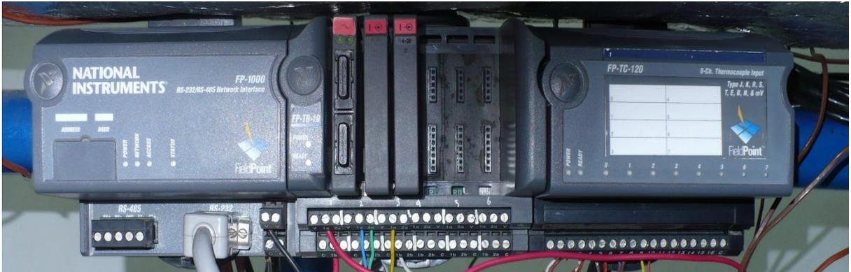
Figura 11-B) se realiza la recolección de datos de los sensores de temperatura y humedad relativa del proceso por parte del equipo Vaisala y en el tercero de ellos se realiza la recolección de los datos de la velocidad del aire.
