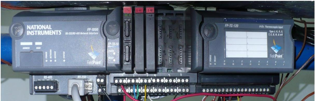
Figura 11-B) se realiza el control, la adquisición y la medición de datos; éste cuenta con la opción de entradas y salidas de señales con múltiples rangos de medición que van desde salidas booleanas, entradas y salidas en mili voltaje, entradas y salidas de voltaje, entradas y salidas a mili Amperaje.
