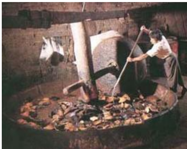
Figura 1. 4 Molino chileno de tracción animal.
