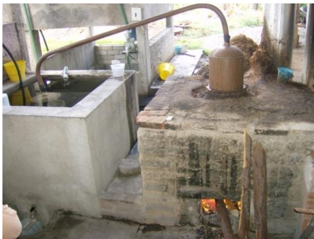
Figura 1. 6 Equipo de destilación predominante en el estado de Oaxaca.
