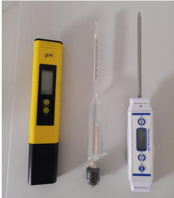
*Figura 20: Medidor de PH, Termómetro y densímetro*
