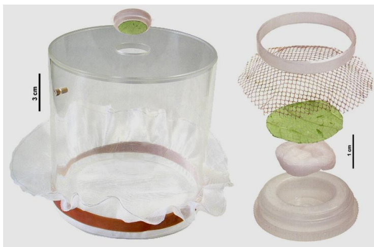
Figura 1. Cilindro de acrílico para la evaluación de repelencia de adultos de mosca blanca
