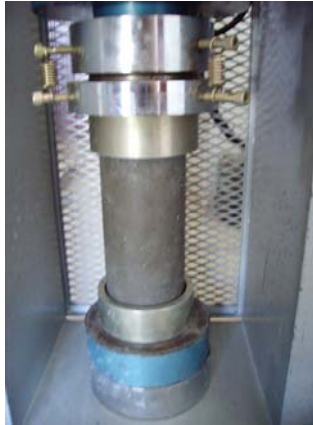
Figura 4. 6 Disposición del dispositivo para la prueba de resistencia a la compresión del concreto
