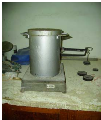
Figura 4. 4 Pesado del concreto para la prueba de peso volumétrico
