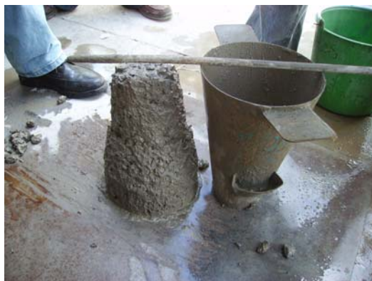
Figura 4. 2 Prueba de revenimiento del concreto
