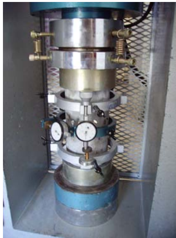
Figura 4. 7 Módulo de elasticidad y relación de Poisson del concreto
