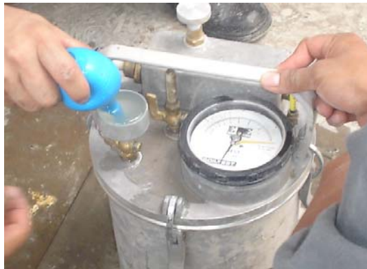
Figura 4. 3 Prueba de contenido de aire atrapado en el concreto
