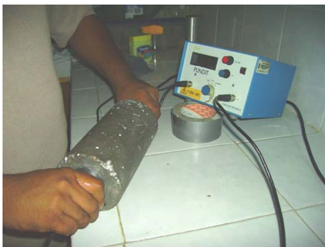
Figura 4. 9 Prueba de velocidad de pulso ultrasónico
