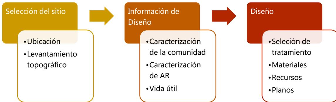
Figura 38. Proceso de diseño de la PTAR. Fuente: Elaboración propia.
