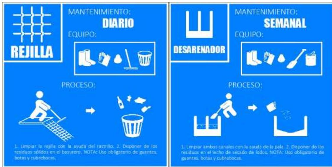
Figura 51. Ejemplo de la señalización instalada en la PTAR para cada elemento. Fuente: Elaboración propia.
