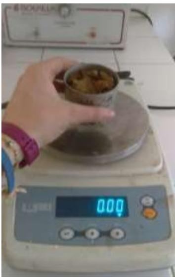
Del material restante en el molde, se toma suficiente para llenar una cápsula de aluminio (que se haya pesado) hasta  $\frac{3}{4}$  partes de su capacidad. Ya llena la cápsula, se procede a pesarse y se registra como: (Peso de cápsula + suelo húmedo)
