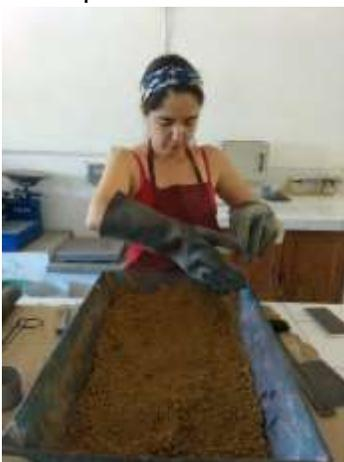
Se prepara una muestra de 3 Kg. de suelo secado al sol, se le incorpora la cantidad de agua suficiente para tenga de un 4 a un 6% abajo de la humedad óptima, se uniformiza la humedad usando guantes. Entonces se procede a llenar el molde Proctor.
