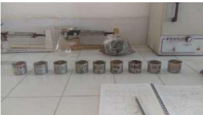
Después de 24 hrs. las cápsulas son extraídas del horno y se pesan, registrándolas como: Peso de cápsula + suelo seco
