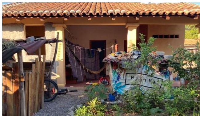
figura: 35 V3 Vivienda construida por La Casa de la Ciudad Oaxaca con materiales de la región con cubierta a base de monten, triplay y tejas en Asunción Ixtaltepec. Foto: tomada por el autor.
