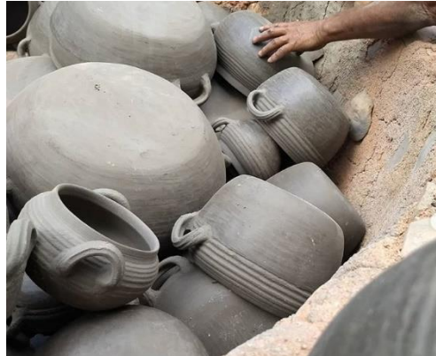
Figura 31 Acomodo de piezas en el horno
