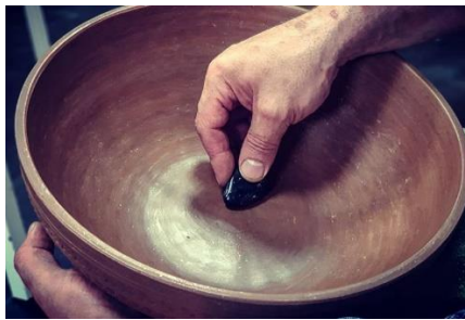
Figura 4 Ejemplo de bruñido con piedra de jade.
