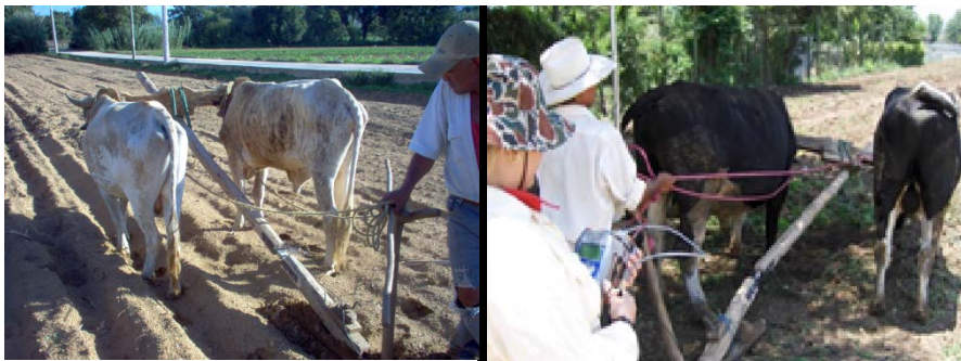
Figura 5. Medición de la fuerza de tracción de los animales de tiro, con celda de carga LCCA-750.
