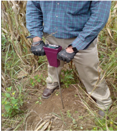
Figura 8. Muestreo de la compactación con penetrómetro marca Spectrum modelo SC-900
