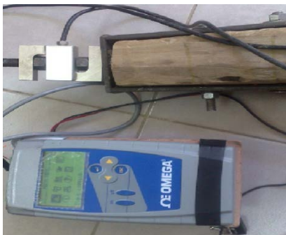
Figura 4. Celda de carga acoplada al arado de palo.
