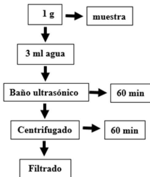
Figura 3.3. Obtención de extractos de manzana osmódeshidratada para análisis por UHPLC-IR.
