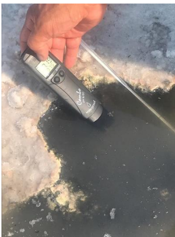
Figura 2 Registro de pH, CE y temperatura de la salmuera en los puntos de muestreo en las lagunas salineras
