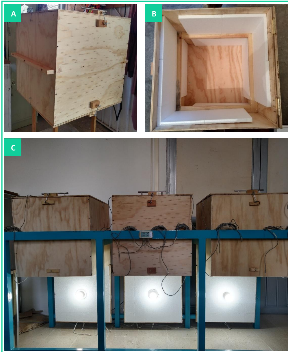
Fig. 4.3.2.1. Cámaras para mediciones térmicas. Fuente: Elaboración propia.
