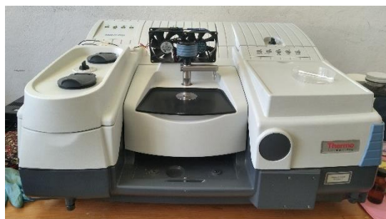
Fig. 4.1.2.1. Colocación del PCM en el equipo de FTIR-ATR. Fuente: Elaboración propia.
