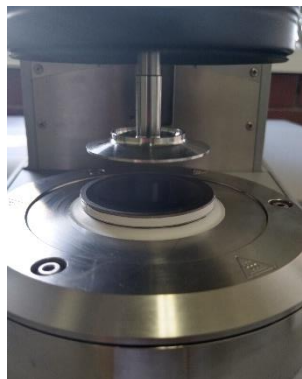
Fig. 4.1.1.1. Colocación de PCM en reómetro. Fuente: Elaboración propia.
