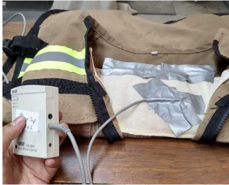
Fig. 4.3.1.1. Colocación termopares en el módulo del chaleco. Fuente: Elaboración propia.
