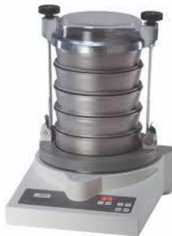
Figura 4. Tamices vibratorios de laboratorio.
