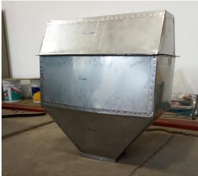
Figura 17. Cámara de separación de la cosechadora.
