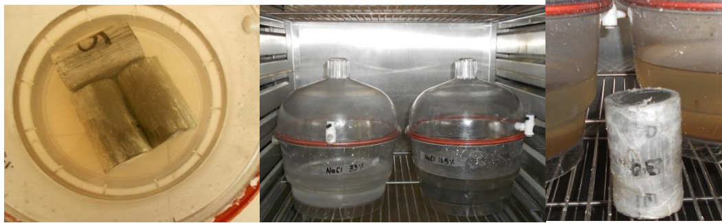
Figura 12. Saturación al vacío de especímenes de pasta de cemento
