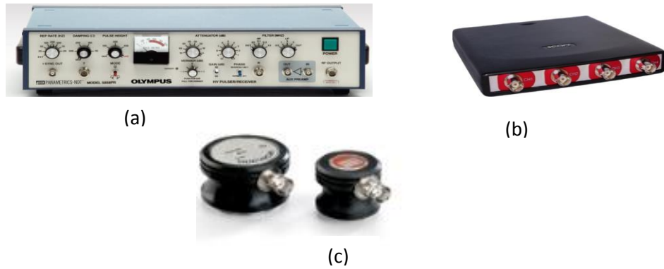
Figura 9. Equipo utilizado para las mediciones ultrasónicas (a) Emisor-receptor 5058-PR, (b) Osciloscopio y (c) Transductores de contacto
