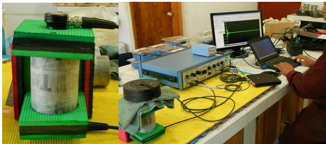
Figura 14. Disposición de los transductores durante las pruebas ultrasónicas
