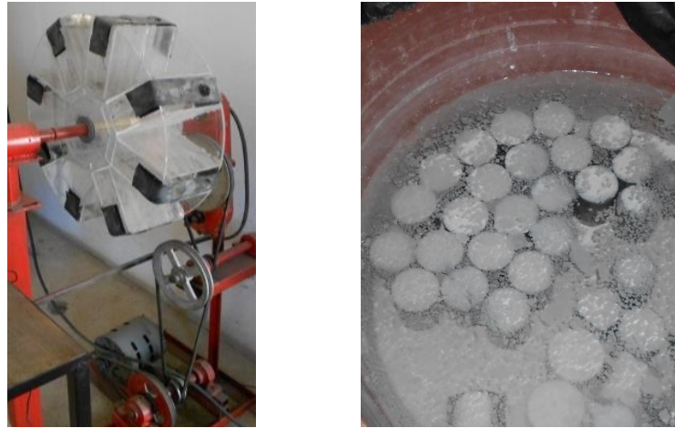
Figura 10. a) Rotación de los especímenes de pasta de cemento y b) curado saturado
