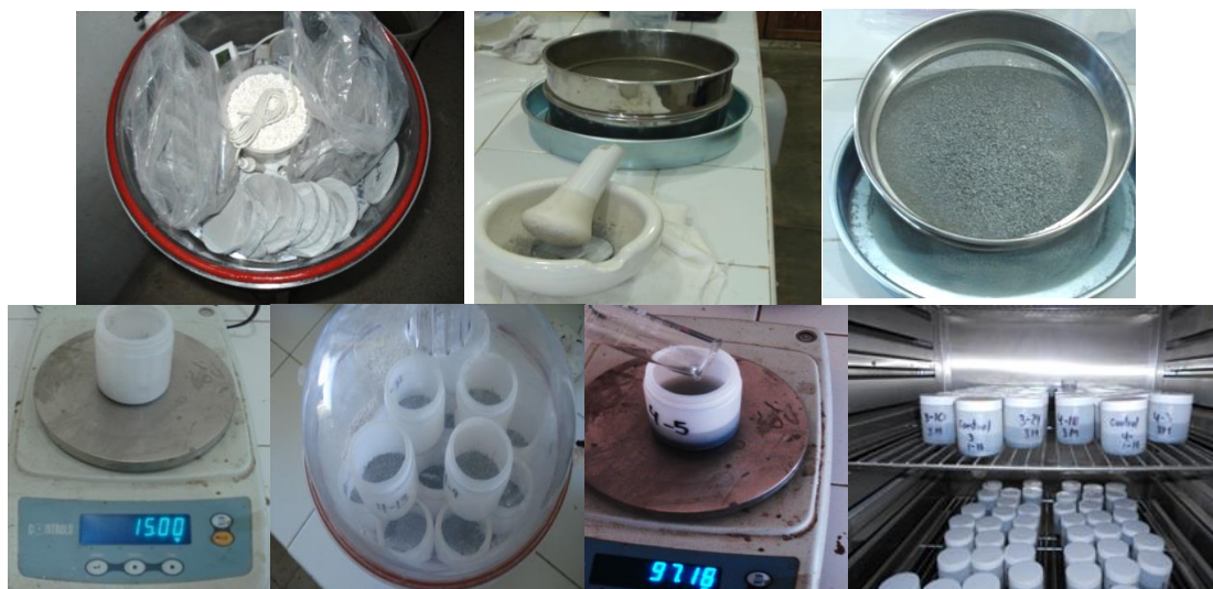
Figura 11. Procedimiento requerido por el método de equilibrio de Tang y Nilsson (1993)
