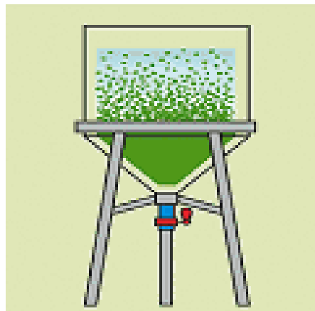
Figura 6. Tolva de 1300 L para propiciar la sedimentación por gravedad en las microalgas.
