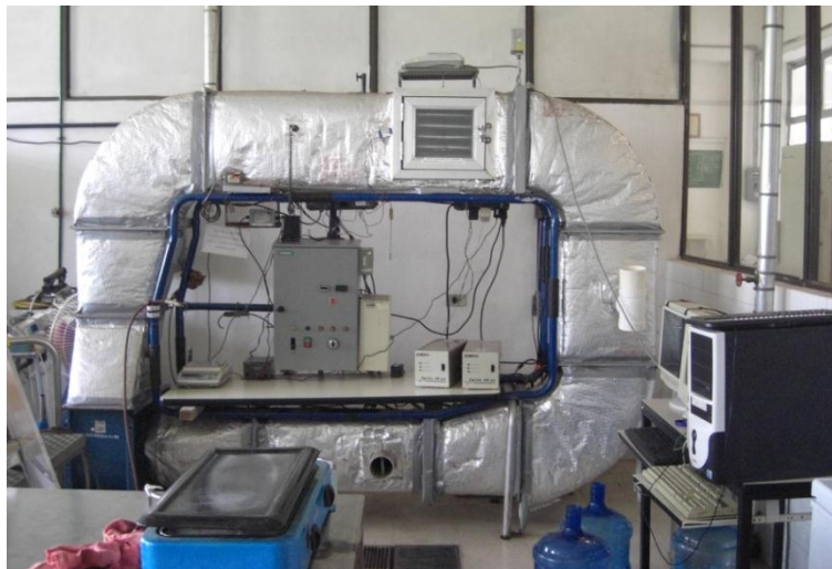
Figura 2. Secador convectivo en forma de túnel que se utilizará en las pruebas de secado.
