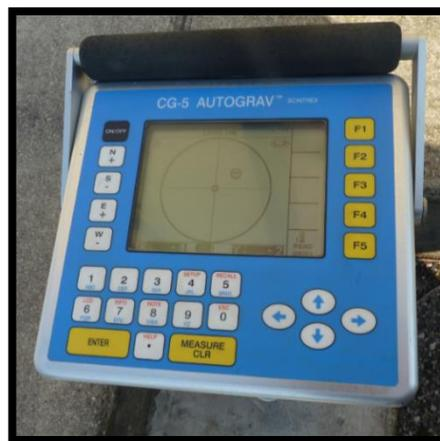
Figura 18. Gravímetro marca Scintrex modelo CG-5 Autograv
