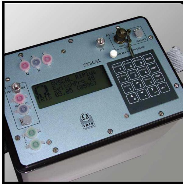
Figura 14. Equipo de medición de resistividad eléctrica Syscal Junior (IRIS Instruments, 2018).
