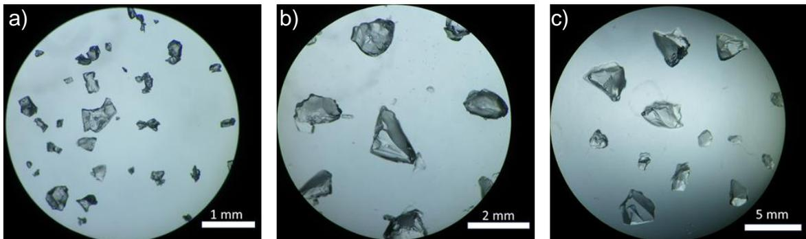
**Figura 22** Tamaño de partícula de PSAk en estado a) seco, b) saturado con solución de KOH+Na<sub>2</sub>SO<sub>4</sub> y c) agua pura.
