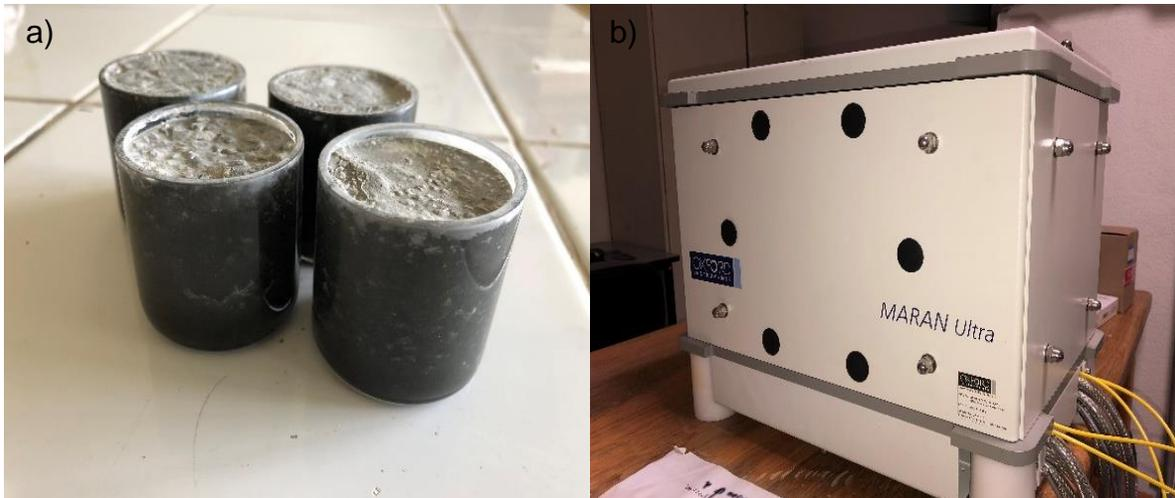
**Figura 14** a) Especímenes cilíndricos utilizados para las mediciones de RMN, b) espectrómetro Maran DRX HF 12/50 NMR 12.9 MHz.
