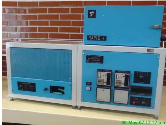
Figura 17. Equipo para estimar la conductividad térmica Dynatech R/D Co.
