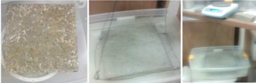
Figura 22. Obtención del peso de la masa sumergida en agua.
