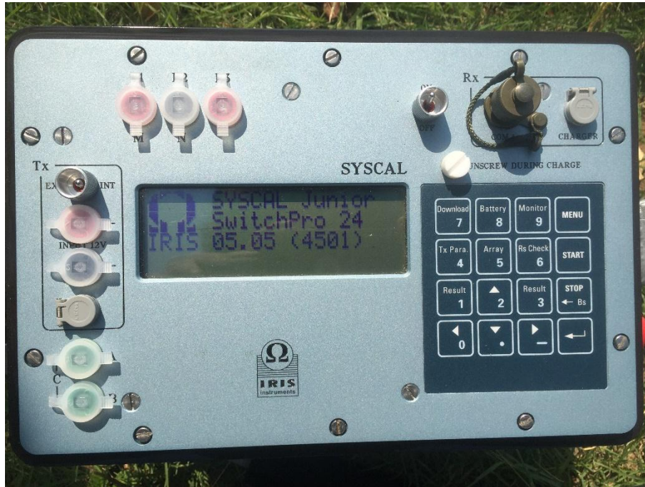
Figura 20 Equipo Syscal Jr SwitchPro de 24 canales de Iris Instruments
