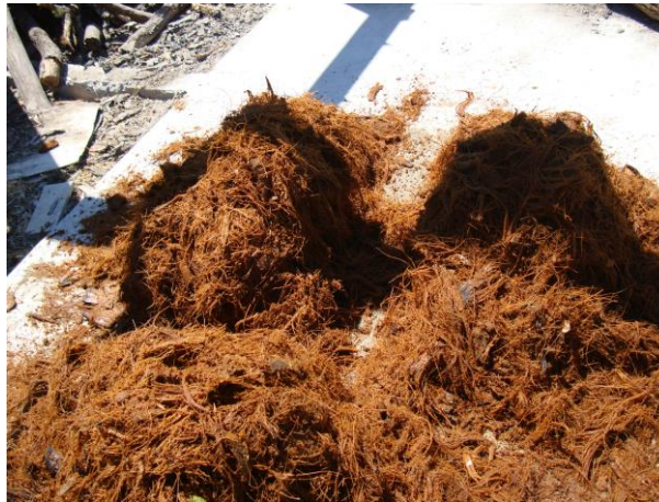
Figura 3-3. Colecta de bagazo de agave, aplicación del método de cuarteo
