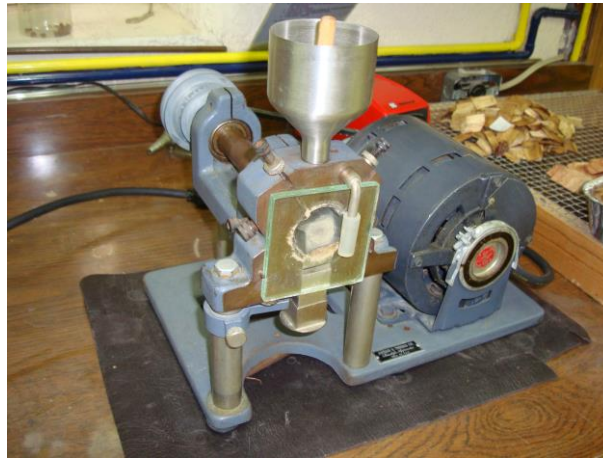
Figura 3-8. Molienda de las fibras
