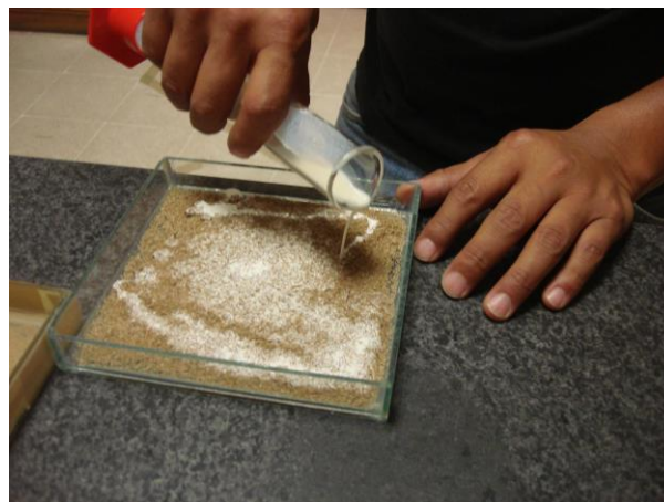
Figura 4-12. Elaboración de las películas del material compuesto
