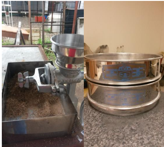
Figura 4-6. Molienda y tamizado de las fibras de bagazo de agave.
