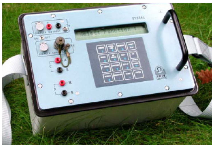
Figura 53. Resistivímetro syscal. Fuente: SYSCAL
