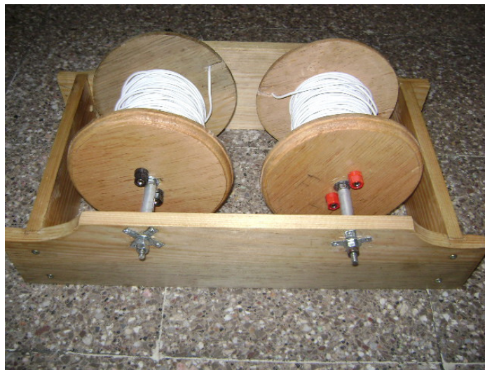
Figura 114. Fotografía de los carretes con cable.
