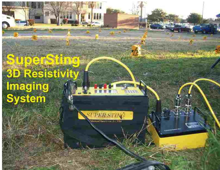
Figura 51. Resistivímetro de 8-Canales. Fuente: AGI Advanced Geosciences, Inc.
