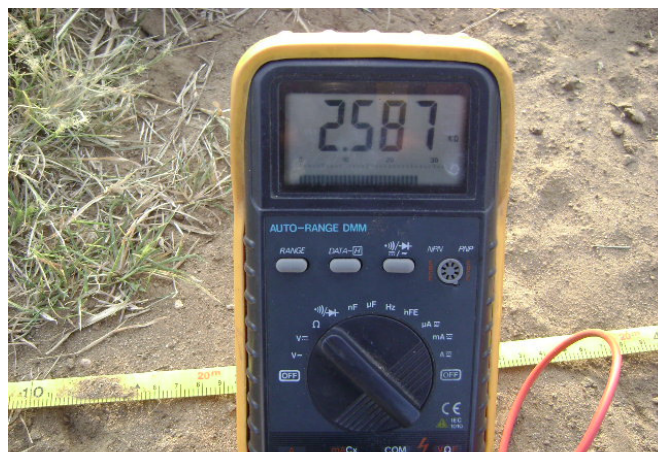
Figura 59. Multímetro utilizado para medir potencial natural.
