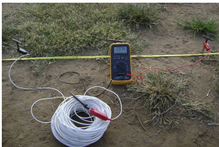
Figura 61. Medición de potencial natural.
