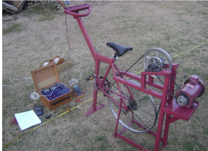
Figura A.2. Generador acoplado a una bicicleta.
