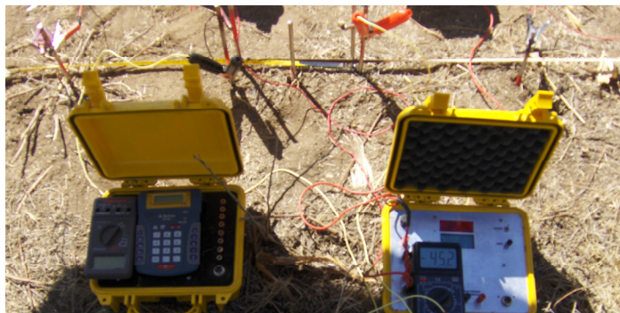
Figura 57. Equipo para mediciones geoelectricas utilizado.
