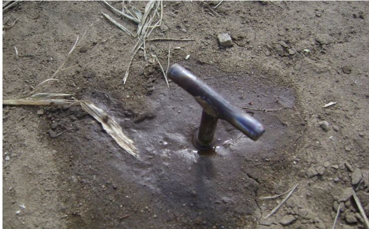
Figura 60. Electrodo en terreno humedecido con agua y NaCl.
