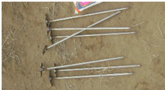
Figura 68. Electrodo de acero para conducir la corriente al subsuelo.
