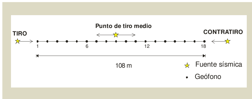
Figura 15. Arreglo de geófonos utilizado para levantamiento sísmico de refracción.
