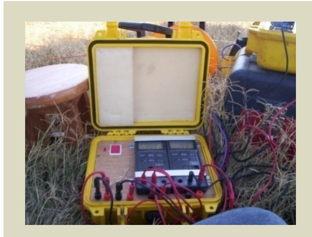
Figura 19. Resistivímetro de corriente directa (CD) utilizado para la recolección de datos de resistividad del suelo.
