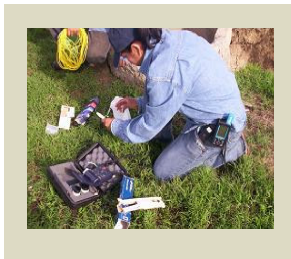
Figura 22. Determinación de parámetros fisicoquímicos del agua utilizando un tester Hanna HI 98129.
