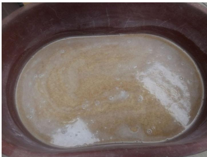
Figura 8. Fibras en  $\text{Ca}(\text{OH})_2$  hidratada
