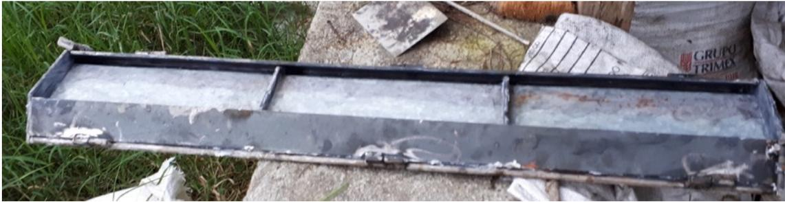
Figura 25. Molde metálico de tejas
