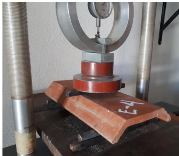
Figura 28. Resistencia a la flexión de 3 puntos
