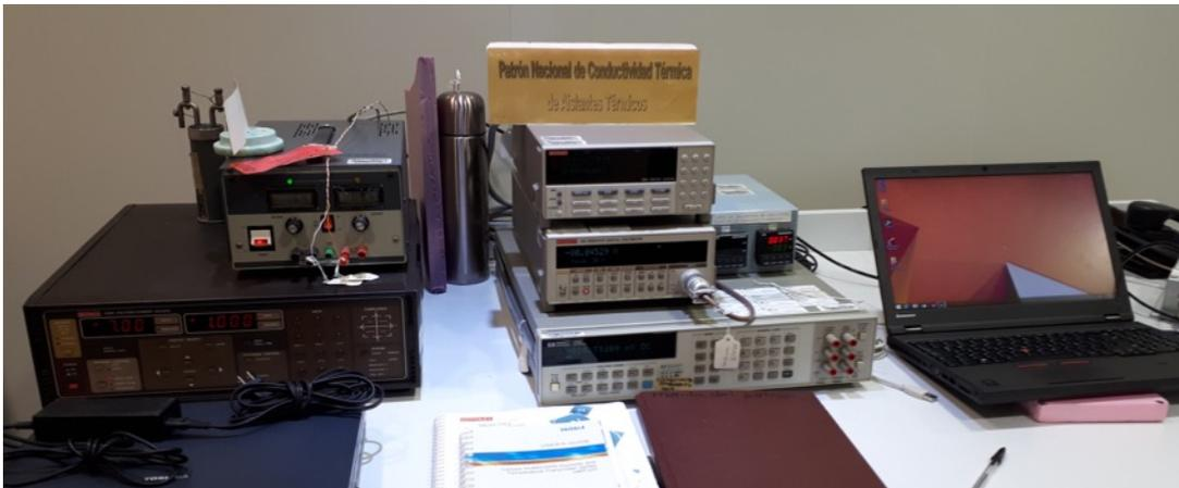
Figura 23. Equipo de medición de conductividad térmica
