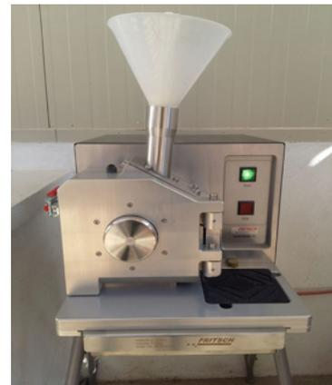
Figura 7. Molino de cuchillas
