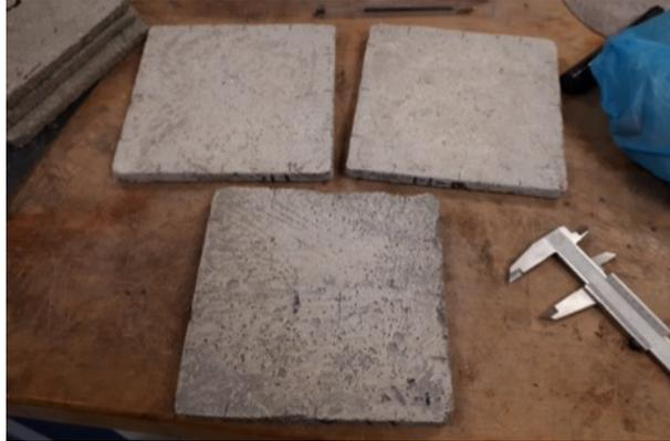
Figura 17. Mediciones de espesor
