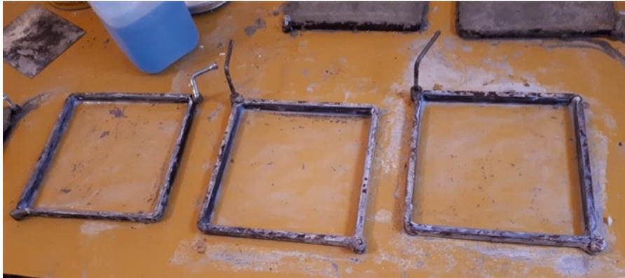
Figura 16. Molde metálico para especímenes.
