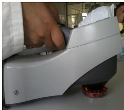
Figura 14. Aplicación del colorímetro para la determinación del color en muestras de fresa seca.
